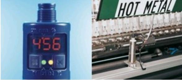
LED 디스플레이 터치컨트롤(왼쪽), 예) 라미네이팅 기계의 소재 직경 측정(오른쪽)
